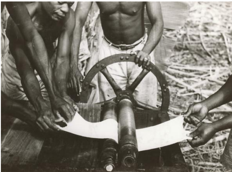
Fabrication de caoutchouc, la masse de latex est essorée, Plantation de caoutchouc Sanaga, 1943, Germaine Krull, 11,5 x 12, ANOM 30Fi60/61
