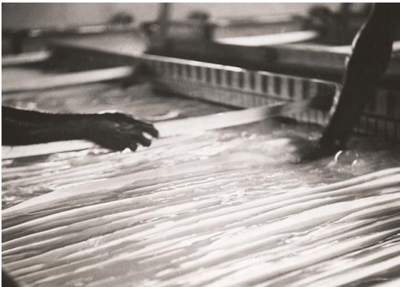
Dizangué, plantation de caoutchouc Sanaga, 1943. La bande de latex déjà coagulée est sortie des cuves. Germaine Krull, tirage argentique collé sur carton 11,5 x 12, ANOM 30Fi60/61
